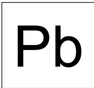
Rys. 5. Ogniwa i akumulatory ołowiowo-kwasowe (oraz wszystkie pozostałe zawierające powyżej 0,004% wagowo ołowiu) muszą być oznakowane symbolem chemicznym ołowiu – Pb
