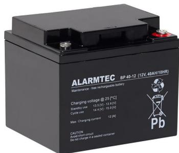
Аккумуляторы выполненные в технологии AGM Absorbed Glass Mat содержат электролит, поглощенный в сепараторы из стеклоткани с высокой пористостью, находящиеся между пластинами. Аккумуляторы AGM имеют небольшое внутреннее сопротивление, что обозначает более высокое напряжение на зажимах и длительное время работы, особенно при разряде большим током.
