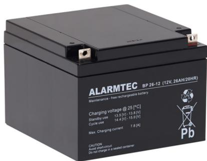
Аккумуляторы выполненные в технологии AGM Absorbed Glass Mat содержат электролит, поглощенный в сепараторы из стеклоткани с высокой пористостью, находящиеся между пластинами. Аккумуляторы AGM имеют небольшое внутреннее сопротивление, что обозначает более высокое напряжение на зажимах и длительное время работы, особенно при разряде большим током.
