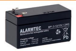
Аккумуляторы выполненные в технологии AGM Absorbed Glass Mat содержат электролит, поглощенный в сепараторы из стеклоткани с высокой пористостью, находящиеся между пластинами. Аккумуляторы AGM имеют небольшое сопротивление, что обозначает внутреннее более напряжение на зажимах и длительное время работы, особенно при разряде большим током.
